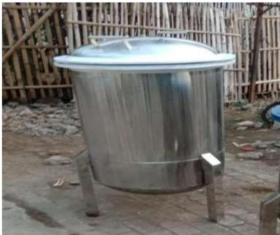
Autoclave sterilisator bibit jamur
